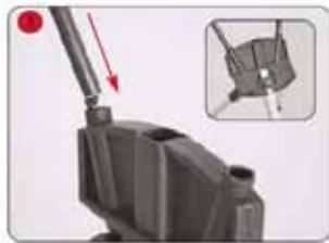
Insérer le mât dans le centre de la structure.
